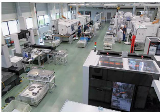
L'atelier 4.0 du site d'Argonay intègre les traitements thermiques aux procédés d'usinage, afin de fluidifier la production, pour des séries aéronautiques de 20 à 400 pièces à haute valeur ajoutée.
