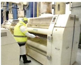
Dans les broyeurs, les grains sont écrasés entre deux cylindres.
