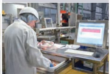
▶ **Acquisition** Dans l'atelier de préparation d'ingrédients pour les plats cuisinés, les balances sont connectées à Qubes pour une remontée automatique des données de pesée.
