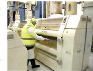
Dans les broyeurs, les grains sont écrasés entre deux cylindres.
